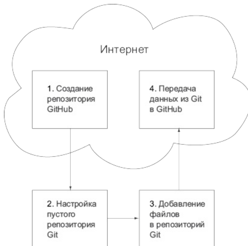
Рис. 14.4. Действия, предпринимаемые для добавления Node-проекта на сайт GitHub
