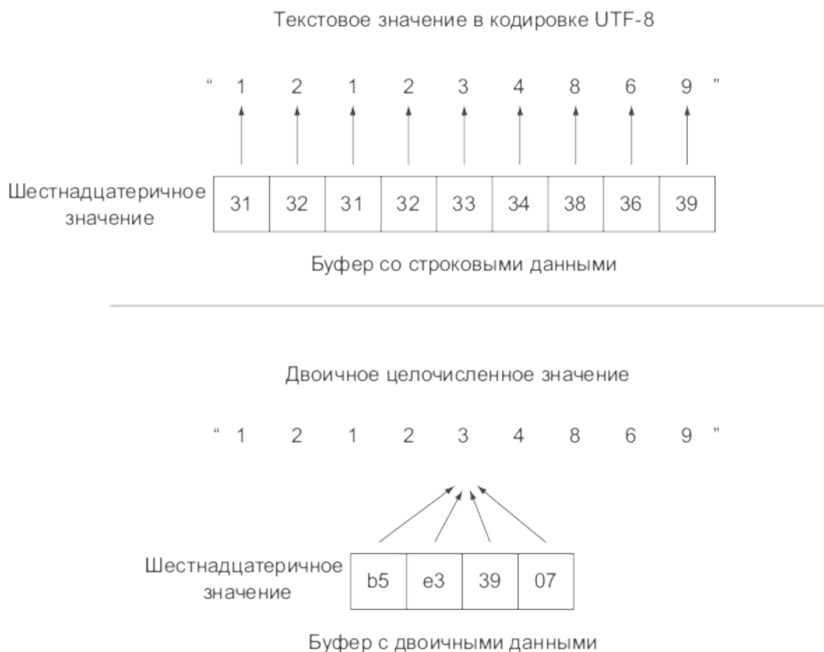
Рис. 13.2. Различные представления на байтовом уровне (порядок байтов от младшего к старшему) числа 121234869: в виде текстовой строки и в виде двоичного целого
