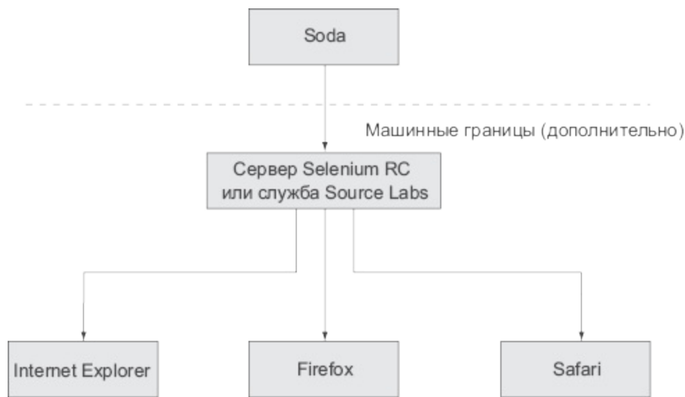
Рис. 10.6. Среда приемочного тестирования Soda обеспечивает удаленное управление реальными браузерами. С помощью сервера Selenium RC или службы Sauce Labs среда Soda предоставляет API-интерфейс, который позволяет Node выполнять непосредственное тестирование, учитывающее реалии разных реализаций браузеров
