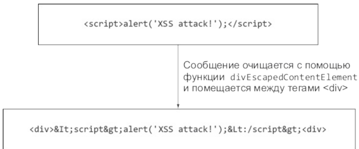
Рис. 2.13. Преобразование специальных символов ненадежного текста в HTML-сущности
