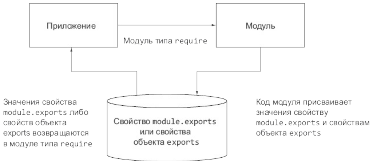
Рис. 3.2. Путем присваивания значений свойству объекта module.exports или свойствам объекта exports можно выбрать в модуле переменные и функции, которые должны использоваться в приложении
