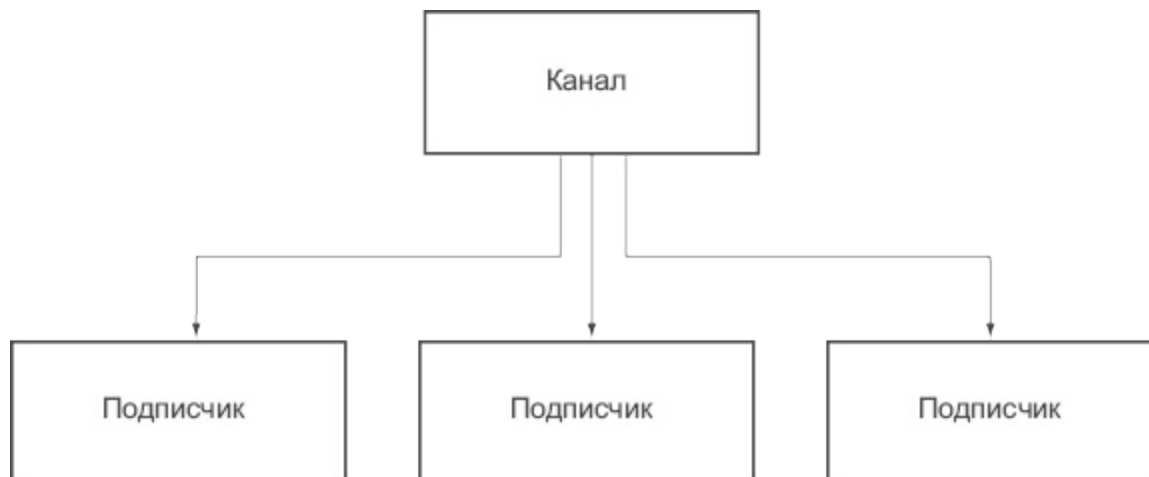
Рис. 5.7. С помощью каналов в Redis реализуется простое решение, обеспечивающее универсальный сценарий передачи данных
