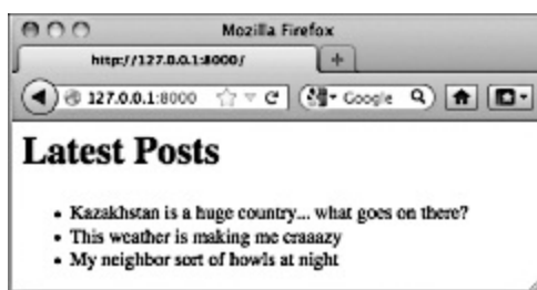
Рис. 3.7. HTML-ответ, полученный от веб-сервера, который извлекает заголовки сообщений из JSON-файла и возвращает результаты в виде веб-страницы
