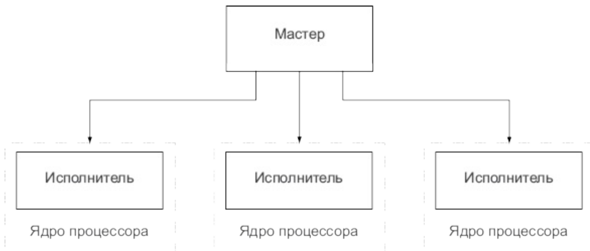
Рис. 12.4. Для выполнения на четырехъядерном процессоре мастер породил трех работников
